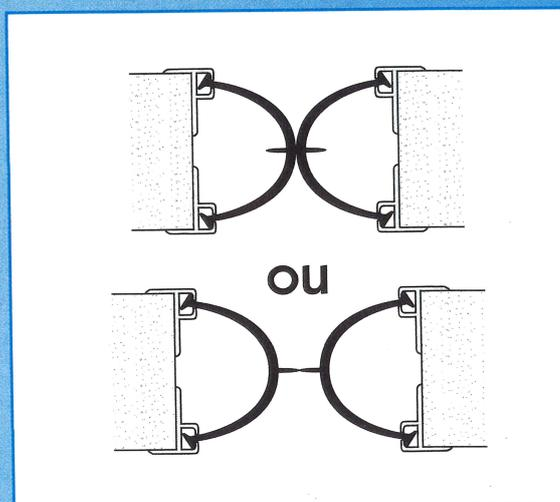
■ joint anti-pince doigts et d'étanchéité pour porte va-et-vient.
