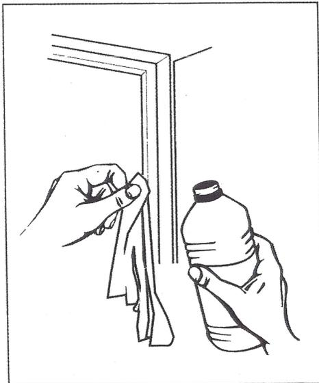
1) Nettoyer soigneusement les feuillures et dormants avec de l'alcool ou du trichlo. Sécher.
