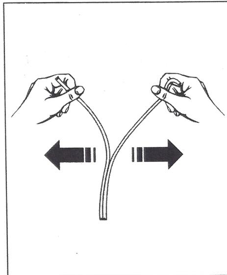
2) Débloubler le joint. Couper à la longueur désirée. Retirer la protection de l'autocollant sur quelques cm.
